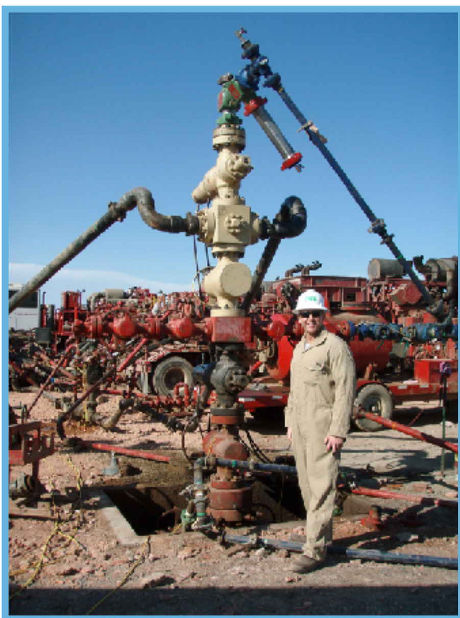
Well Head where fluids are injected into the ground (Cabeza de un pozo de facturación hidráulica, desde la que se inyectan los fluidos al subsuelo) Foto: Joshua Doubek (Fuente: Wikipedia / imagen reproducida bajo licencia Creative Commons)
