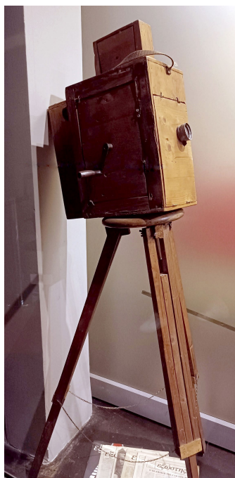
Fig.1. Cámara de principios del s. xx, accionada por manivela. Museo del cine de Tesalónica. Foto propia.
